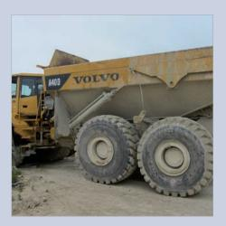
Im Schotterwerk Brugger GmbH ist seit Juni 2015 der knickgelenkte Dumper von Volvo (A40 D) auf beiden Hinterachsen mit BKT SR 41 in der Größe 29.5 R 25 ausgerüstet.
